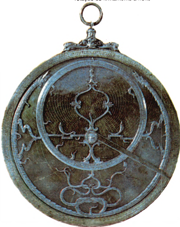
Astrolábios. Mediam o ângulo do sol ou das estrelas acima do horizonte ou simulavam a rotação do firmamento à noite
