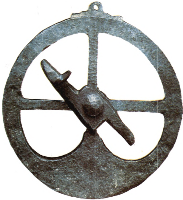
Astrolábios. Mediam o ângulo do sol ou das estrelas acima do horizonte ou simulavam a rotação do firmamento à noite
